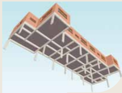
Vista inferior de uma laje convencional
